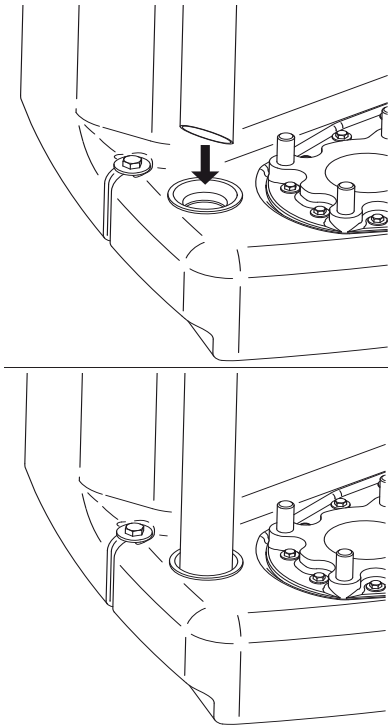
Fig. 11: Raccordement du tuyau d'aspiration pour la pompe à membrane manuelle
