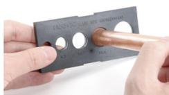
Vérifier que l'évasement est correct à l'aide de l'outil de contrôle de l'évasement.
