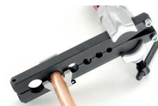
Fixez fermement le tube en place, retirer l'outil d'évasement Tasco.
